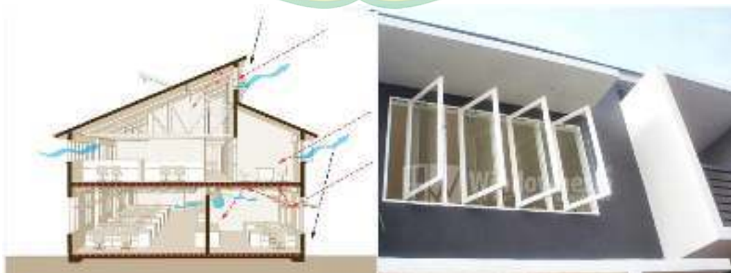
Gambar 5.2 Penggunaan ventilasi silang dan jendela bukaan besar Sumber : Analisis, 2024
