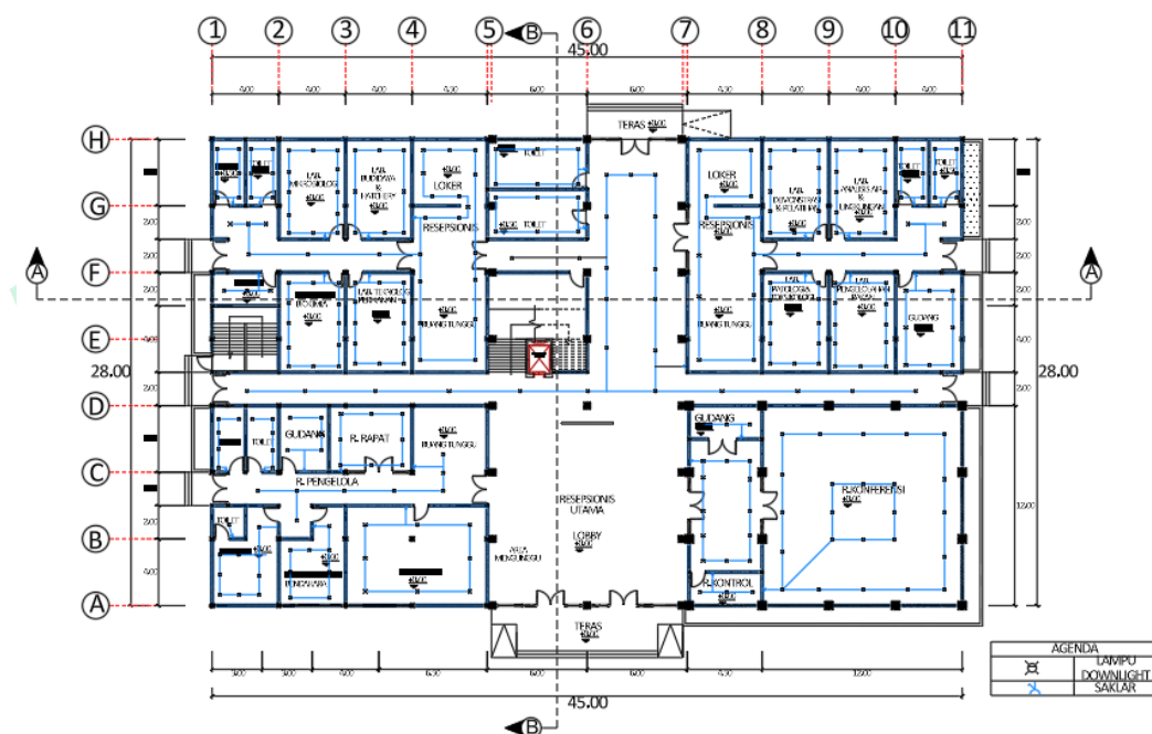
Gambar 5.9 Skema jaringan listrik Sumber : Analisis pribadi, 2025
