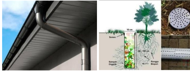
Gambar 4. 6 Penggunaan talang air & Sumur resapan, Sumber : Analisis pribadi, 2025
