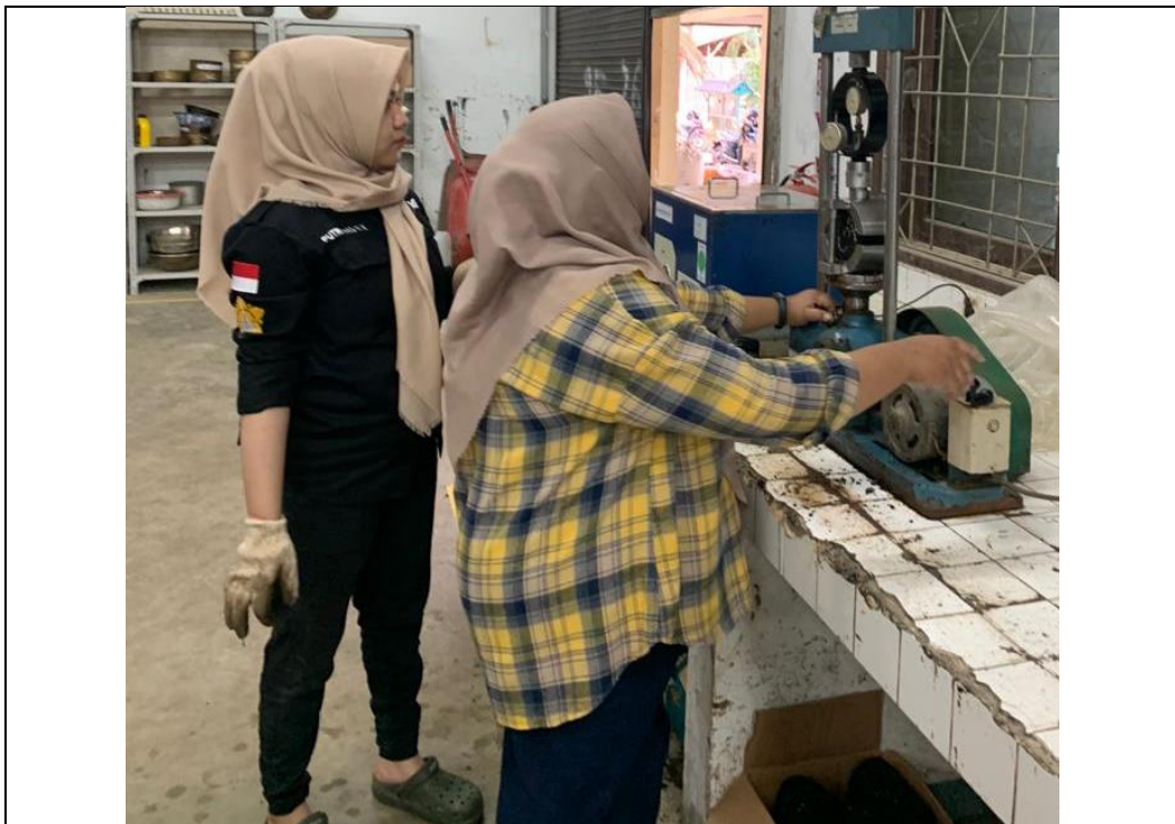
Gambar D.4.10 : Pengujian Marshall Sumber : Dokumentasi
