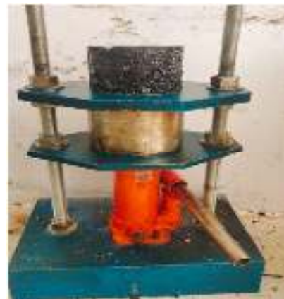
6. Benda Uji dikeluarkan dari Mold
