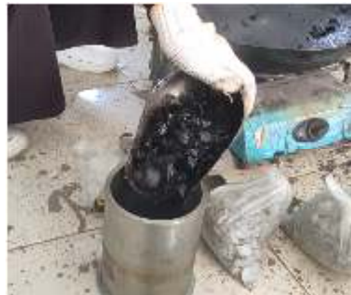
2. Benda Uji dimasukkan dalam Mold
