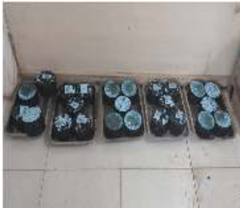
7. Diamkan Benda Uji Selama 2x24 jam dengan suhu 22°
