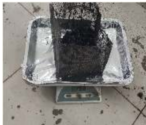
4. Masukkan Benda Uji dalam keranjang dan Timbang
