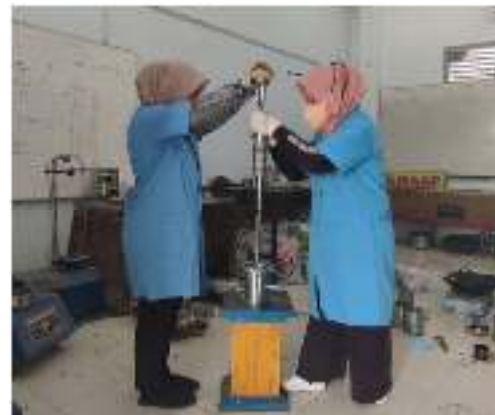
4. Pemadatan Benda Uji
