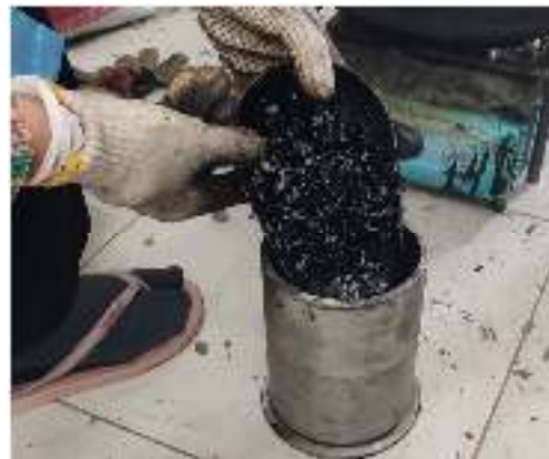
2. Benda Uji dimasukkan dalam Mold
