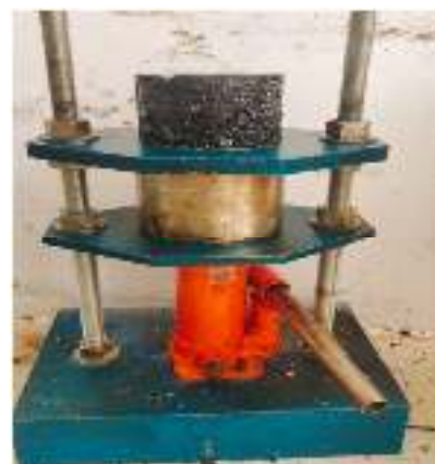
6. Benda Uji dikeluarkan dari Mold
