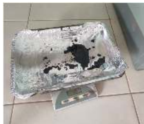
6. Penimbangan Aspal Yang lengket pada Nampan
