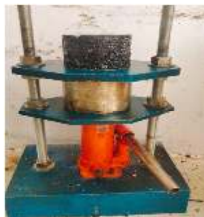
6. Benda Uji dikeluarkan dari Mold
