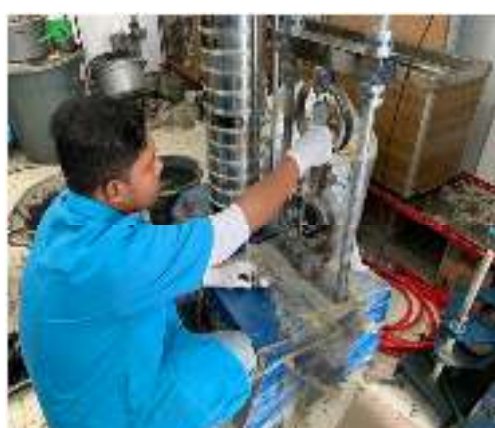
12. Benda Uji dites menggunakan Mesin Marshall Test
