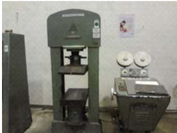
Gambar A.4.7 : Mesin Uji Kuat Tekan
