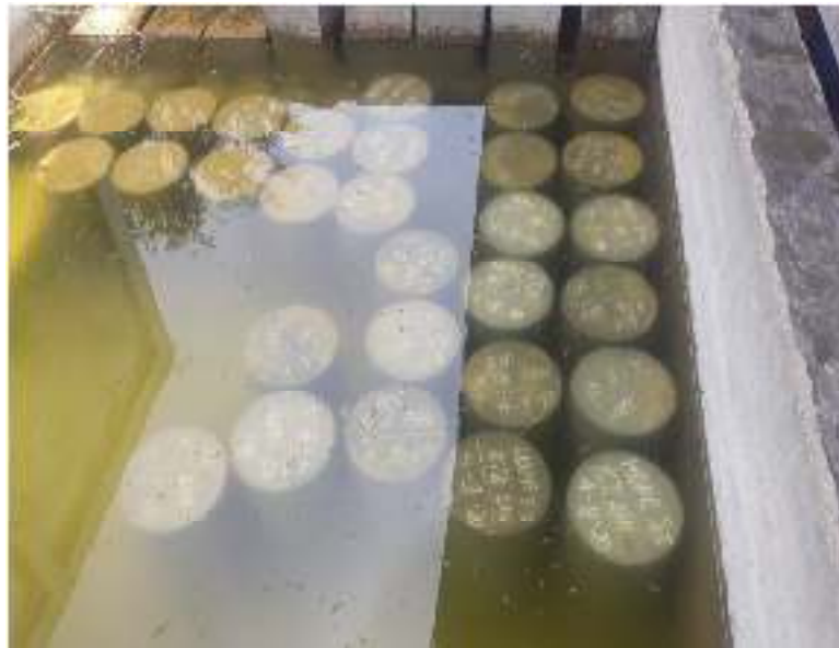
Gambar A.7.1 : Perawatan Benda Uji
