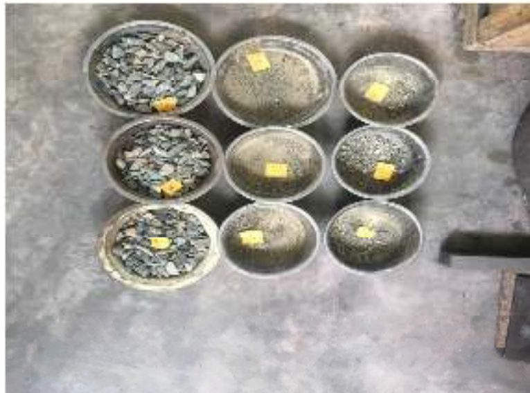
Gambar A.6.1 : Pemeriksaan sifat fisis agregat sudah ditimbang
