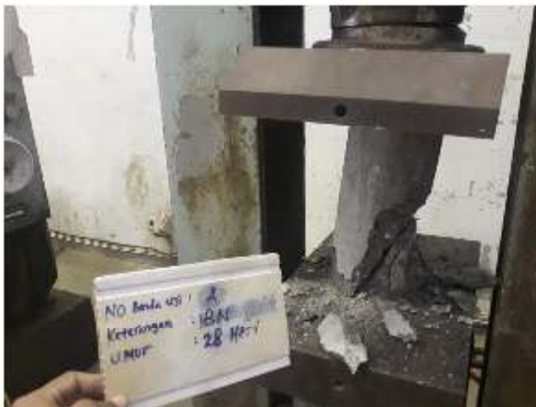
Gambar A.8.2 : Pengujian Kuat tekan
