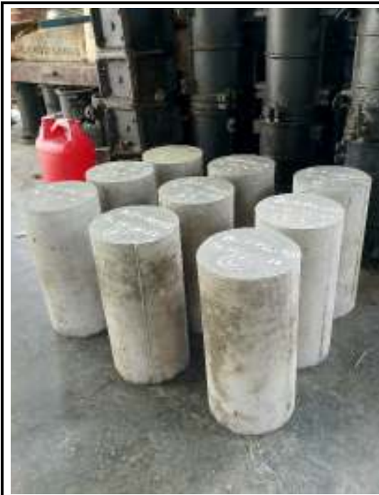
Beton Camp. P. Sungai Umur 7 Hari
