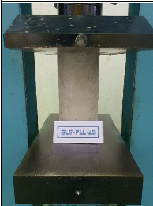
Proses Pengujian Kuat Tekan
