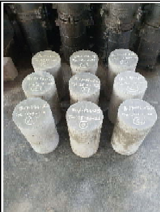
Beton Camp. P. Sungai Umur 7 Hari
