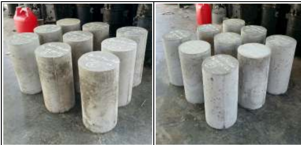
Gambar 4.1 : Setelah Perawatan Benda Uji Silinder Beton
