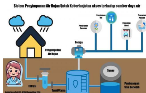
Gambar 2.24 Sistem Pengumpulan Air Hujan (Sumber : https://rm.id/baca-berita/ekonomi-bisnis/ , 2024)
