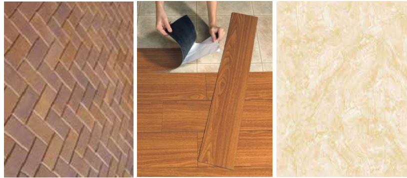
Gambar 5.9 Paving Block, Lantai vinyl, dan keramik Sumber: Dokumentasi pribadi, 2023
