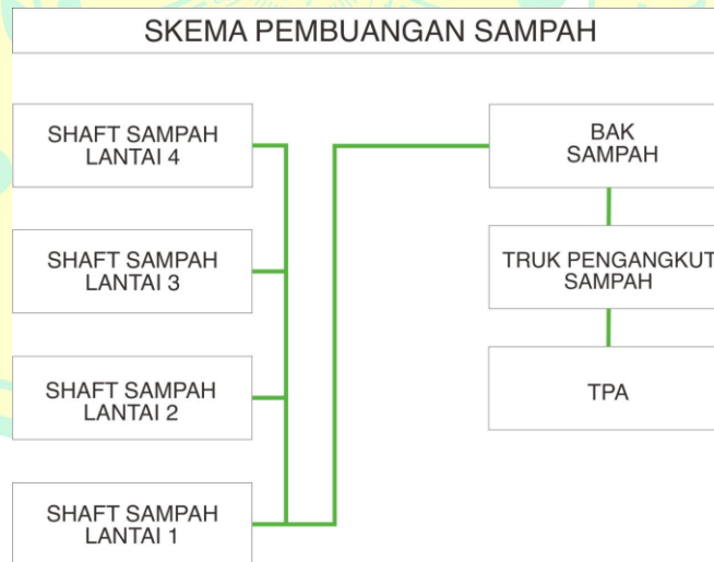
Gambar 5. 12 Instalasi Pembuangan Sampah (Sumber: Analisis Pribadi, 2025)
