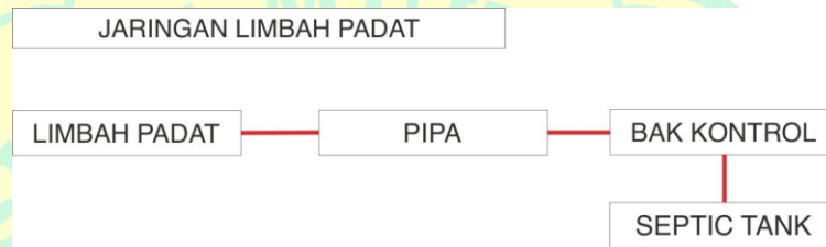
Gambar 5. 11 Instalasi Limbah Padat (Sumber: Analisis Pribadi, 2025)
