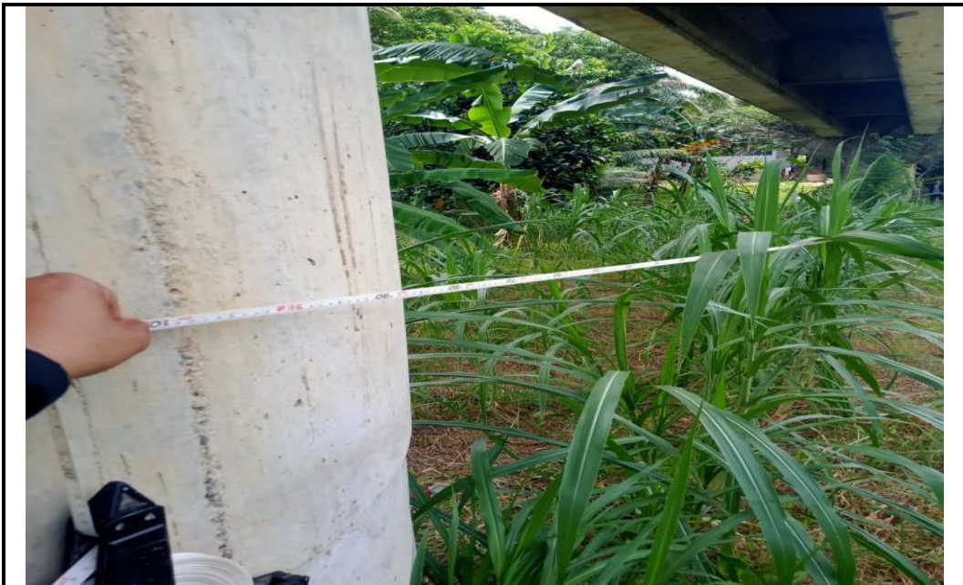
Gambar A.7 : Pengukuran langsung panjang pilar ke pilar Sumber : Lokasi Penelitian (2021)
