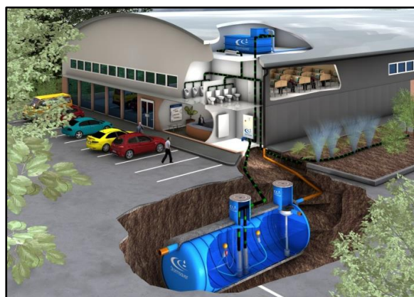
Gambar 5.4 Kerja Penyaringan Air Hujan (Sumber : Analisis, 2018)
