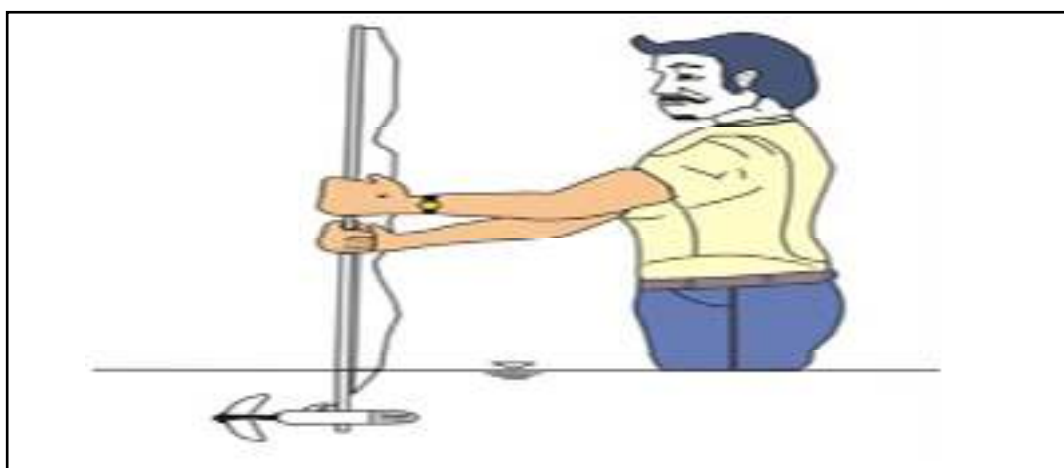
Gambar 2.4 Ilustrasi cara pengukuran debit menggunakan current meter Sumber : Raharjabayu. 2011.
