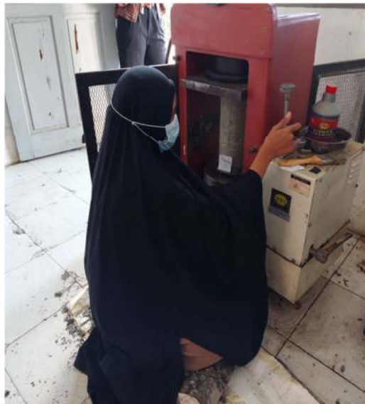
Gambar: A.14 Proses Uji Tekan
