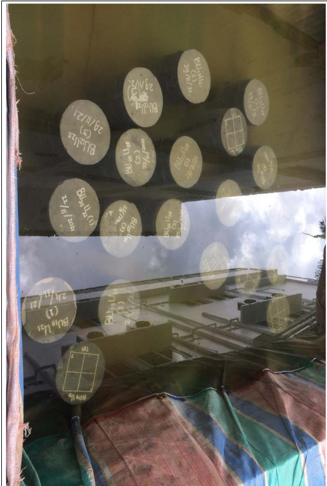
Gambar: A.12 Proses Perawatan Benda Uji Umur 3 hari, 7 hari, 14 hari, dan 28 hari
