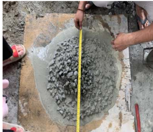
Pengujian slump arah vertikal
