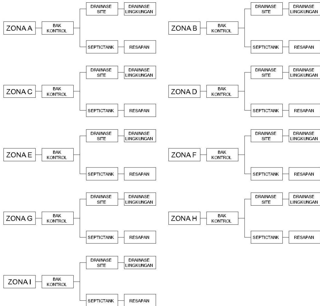
Skema 5.3 Instalasi Kotoran Cair & Padat (Sumber : Analisis 2022)
