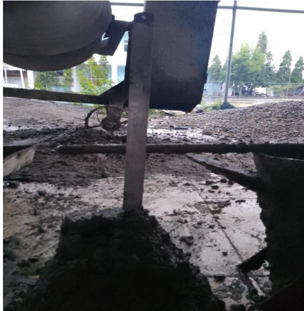
Gambar A.16 : Pengujian Slump Test 7,5 cm – 10 cm
