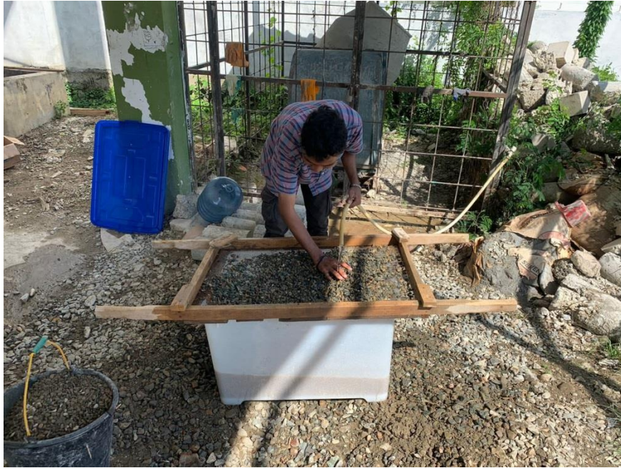
Gambar A.10 : Pencucian Agregat Halus dan Agregat kasar
