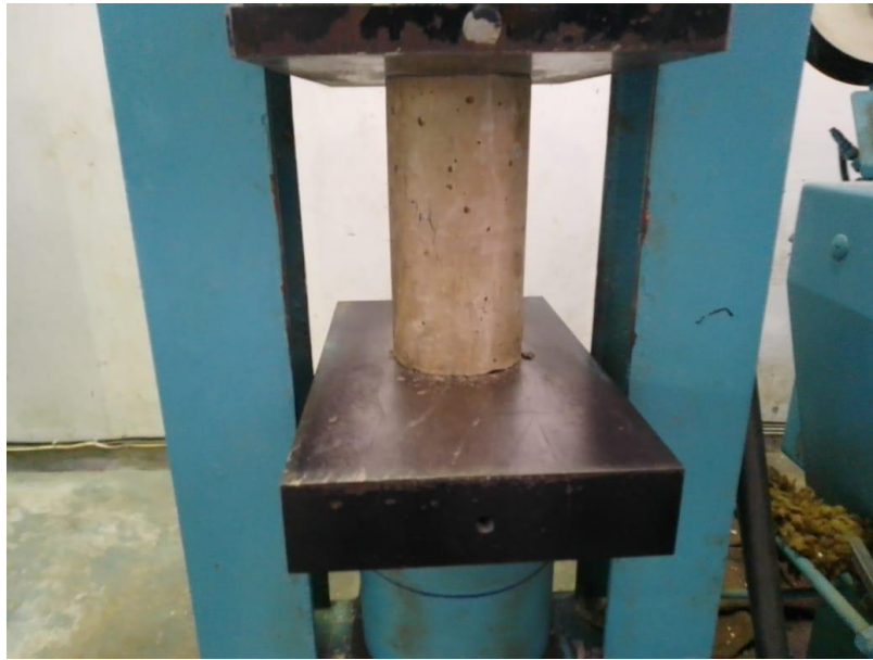
Gambar A.20 : Pengujian kuat tekan beton Air Payau
