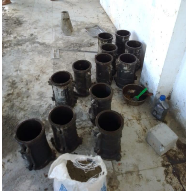
Gambar A.14 : Persiapan mal cetakan
