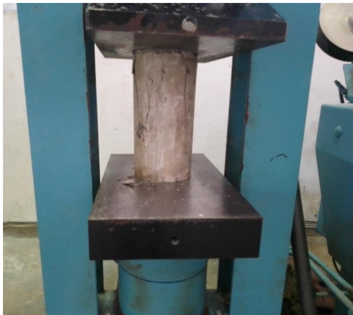
Gambar A.19 : Pengujian kuat tekan beton Air PDAM
