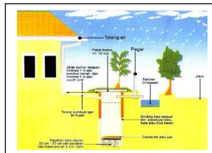
Gambar: 5.18 Sistem jaringan drainase (Sumber : Dokumen Pribadi, 2020)
