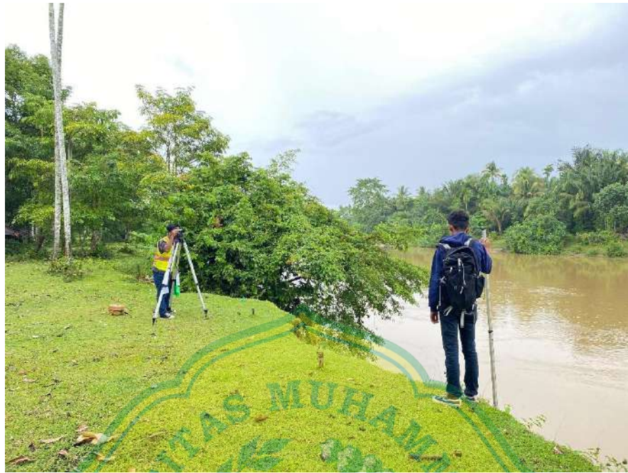
Gambar A.3.9 : Gambar Pengukuran Lereng Sungai
