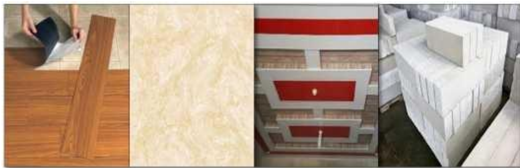
Gambar 5.12 Lantai vynil dan keramik, plafon gypsum dan bata ringan Sumber : Dokumentasi pribadi, 2021
