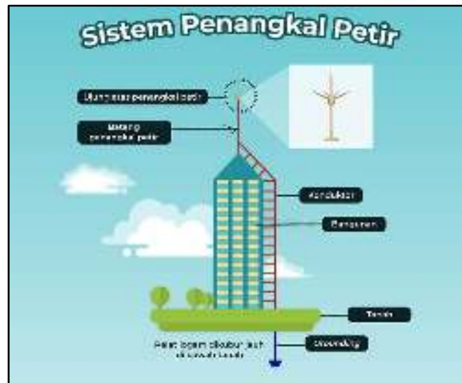
Gambar : 4.22. Penangkal petir sistem Faraday Sumber : analisis, 2023
