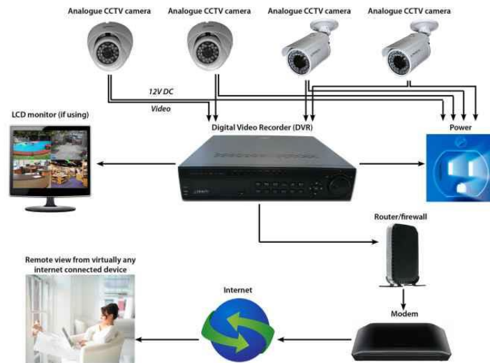
Gambar : 4.27 Sistem CCTV
