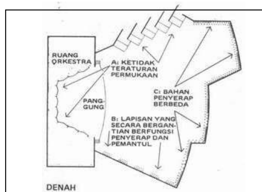
Gambar 2.18. Difusi bunyi yang merata dalam auditorium (Sumber :Akustik Lingkungan, Doelle 1990)
