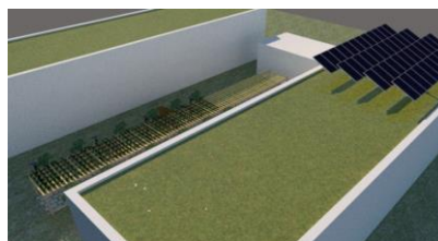
Gambar 5.18 Atap GreenRoof dan Solar Panel Sumber: Dokumen Pribadi
