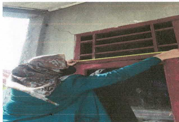
Pengukuran luas ventilasi
